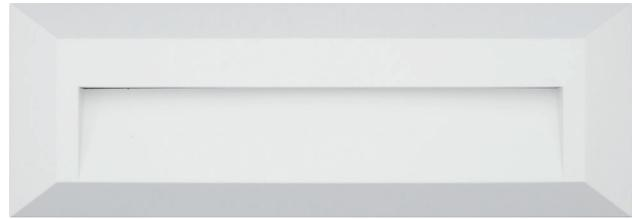
Baliza para pared modelo DAKAR, instalación en superficie y apta para exteriores con un índice de protección IP65. Potencia de 3.5w y luminosidad de 340lm. Iluminación indirecta hacia abajo y 3 temperaturas de color seleccionables mediante DIP switch. Grado de protección de resistencia mecánica a impactos IK08. Cuerpo de ABS y acabado blanco.
