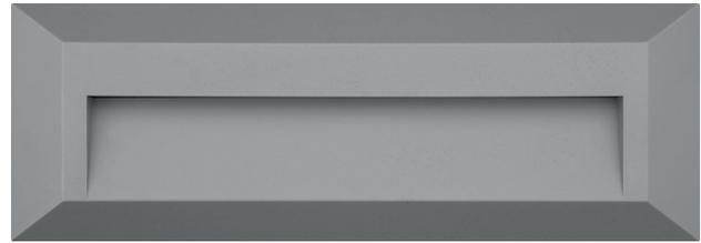
Baliza para pared modelo DAKAR, instalación en superficie y apta para exteriores con un índice de protección IP65. Potencia de 3.5w y luminosidad de 340lm. Iluminación indirecta hacia abajo y 3 temperaturas de color seleccionables mediante DIP switch. Grado de protección de resistencia mecánica a impactos IK08. Cuerpo de ABS y acabado gris.
